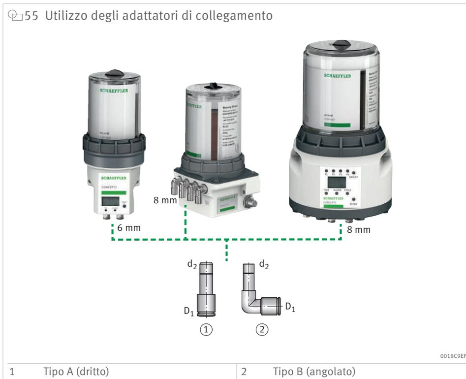
L'adattatore di collegamento con il diametro esterno  $d_2$  viene inserito nell'uscita dell'ingrassatore fino all'arresto finale. Quindi, il tubo del lubrificante viene inserito nel diametro interno  $D_1$  dell'adattatore di collegamento.
