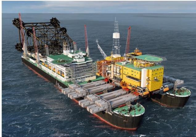
Weltgrößtes Spezialschiff zur Montage und Demontage von Ölbohrplattformen
