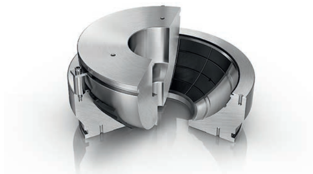
PTFE含有ガラス繊維強化プラスチック材を用いたアキシアル球面すべり軸受
