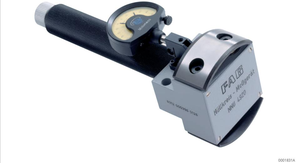
Bei Zylinderrollenlagern mit abziehbarem Außenring NN30ASK ergibt sich die Radialluft oder die Vorspannung aus der Differenz der Durchmesser der Laufbahn E und des Außenhüllkreises  $H_a$ . Unter dem Außenhüllkreis versteht man den Kreis, der alle Rollen von außen berührt, wenn sie an der Innenringlaufbahn anliegen.
