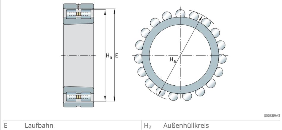
Der Außenhüllkreis wird mit dem MGA 31 gemessen. In Verbindung mit einem Bohrungsmessgerät lässt sich die Radialluft des eingebauten Lagers bestimmen.
