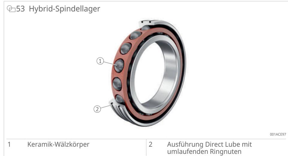
Hybrid-Spindellager erreichen sehr hohe Drehzahlen, haben eine niedrigere Reibung und Wärmeentwicklung, eine höhere Gebrauchsdauer, beanspruchen den Schmierstoff geringer und sind unempfindlich bei Mangelschmierung.
