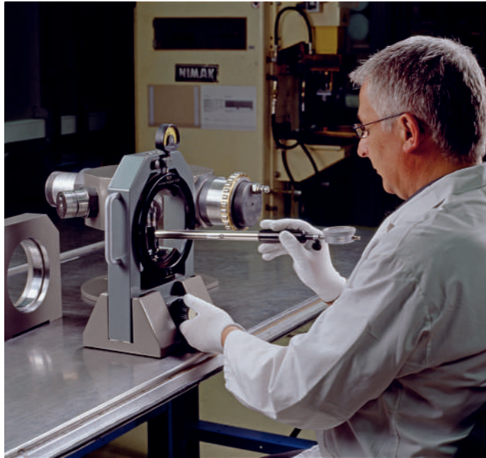
33 Laufbahndurchmesser auf das Hüllkreismessgerät übertragen
