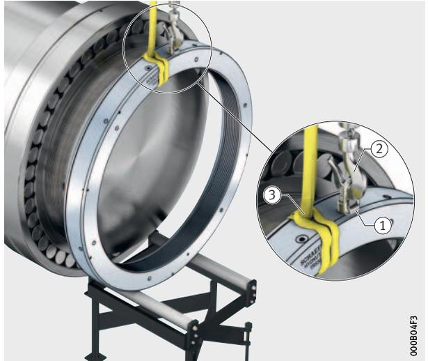
► Hydraulikmutter stoß- und schwingungsfrei transportieren,
