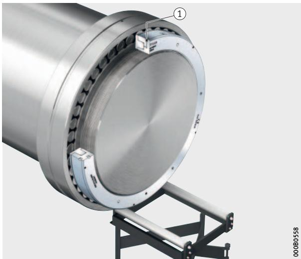
① Radiale Gewindebohrung  $G^{1/4}$
