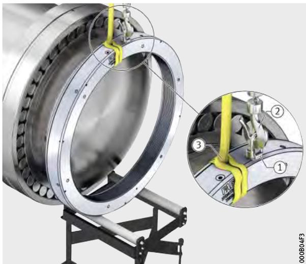
► Transporter l'écrou hydraulique sans chocs ni vibrations, *figure 37.*
