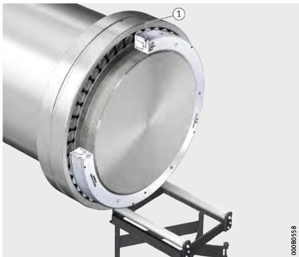
① Orifice fileté radial G<sup>1</sup>/<sub>4</sub>
