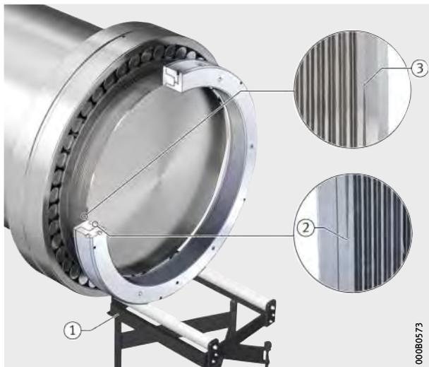
Le déplacement de l'écrou hydraulique expose l'utilisateur à un risque élevé de blessures, en particulier pour les mains.
